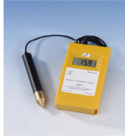
Abb. 2-13: Bild der FKM Messung und das Präzisionstestlameter
