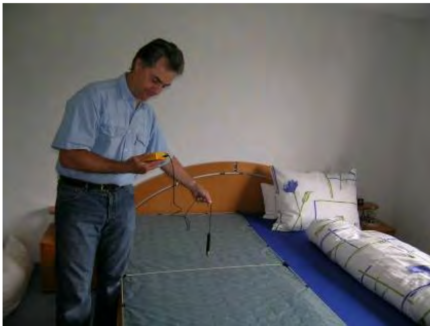
Bild 2: Detailansicht Messraster und Messsonde
