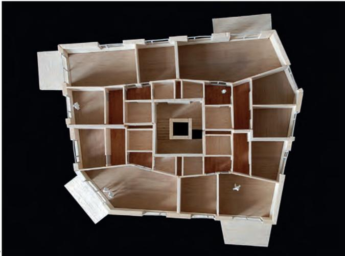
2 Am Modell lässt sich das Zwiebelschalenprinzip ablesen: Vom inneren Kern aus gelangt man nach und nach über „reinigende“ Schleusen in die Aufenthaltsräume an den Außenseiten des Gebäudes.
